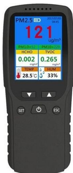
Rys.1. wykorzystane w badaniach urządzenie pomiarowe, umożliwiające szybkie określenie stężenia w powietrzu m.in. pyłów PM 2,5; PM 10
